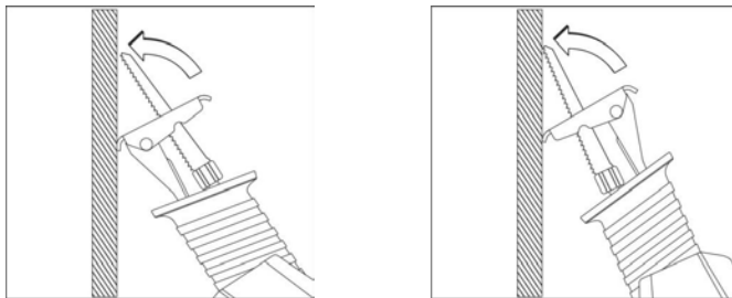
(prawidłowe ułożenie stopki podczas cięcia wgłębnego)
